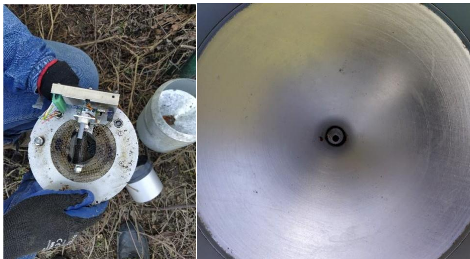
Ilustración 42: Limpieza del pluviómetro
