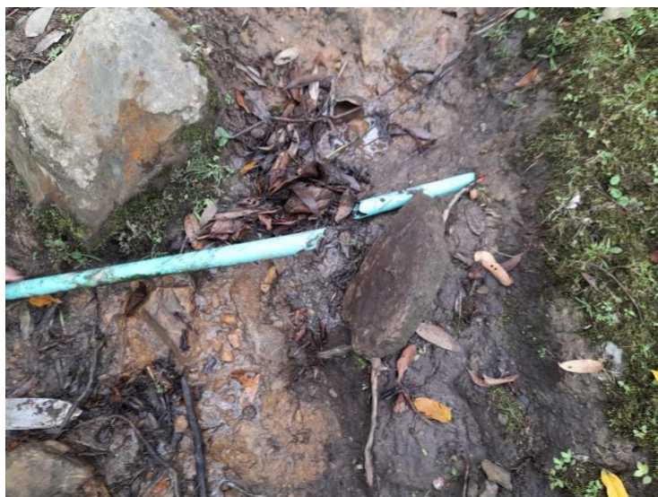
Ilustración 9: Ducto PVC y cables cortados del sensor geófono. Candado oxidado
