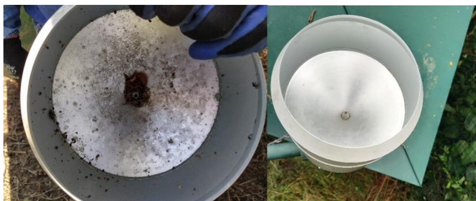
Ilustración 24: Limpieza del pluviómetro
