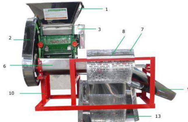
1. Máquina despulpadora pechero FIJO de dos chorros, con capacidad de 300 a 400 KG hora café cereza, cilindro horizontal con camisa en acero inoxidable, volante tipo A, tolva y chorrera en acero inoxidable.
